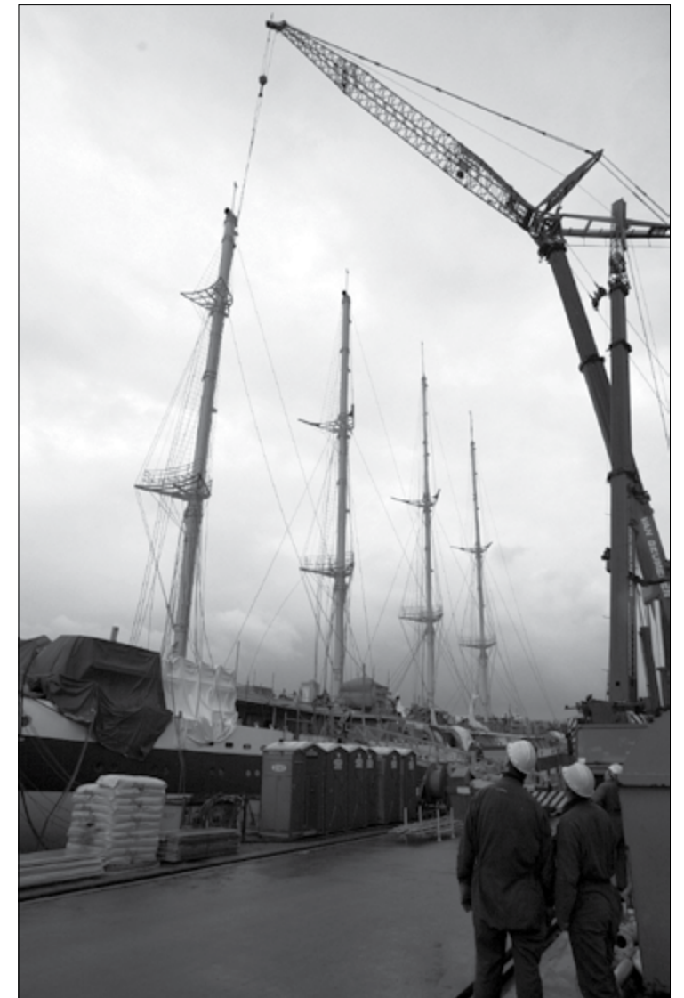
In april 2000 werden op de werf van HVO de masten van een stalen clipper geplaatst. (Foto: Roel Dijkstra)
