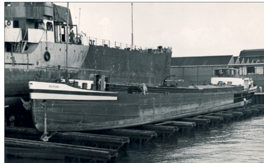
Mvs. RAPIDE, op een dwarshelling bij HVO, voor groot onderhoud. De schipper is achterop zelf aan het teren. (Foto: Museum Vlaar- dingen / Adrie Elen / Archief HVO)
